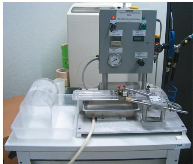
Abb. 1. Übersichtsaufnahme der Testanlage mit abgenommener Plexiglasabdeckung
